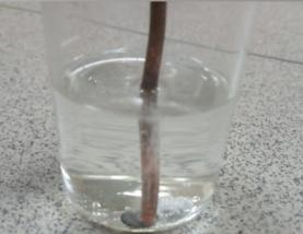
**Схема гальванической цепи Zn | H<sub>2</sub>SO<sub>4</sub> | Cu**
