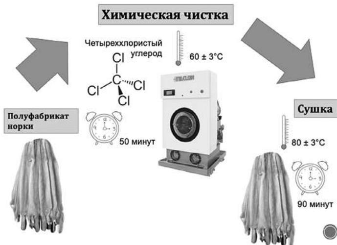
Рис. 2. Схема химической чистки мехового полуфабриката норки
