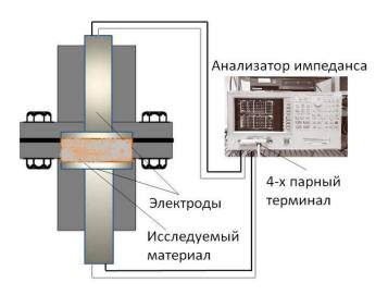
Рис. 2. Установка исследования импеданса и электропроводности
