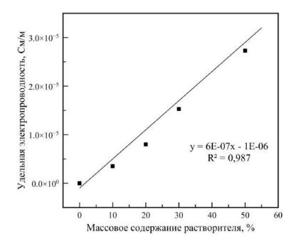
Рис. 4. Зависимость удельной электропроводности  $\sigma^*$  от массового соотношения растворителя
