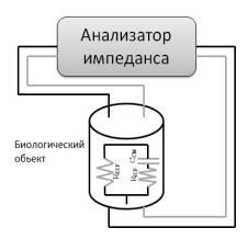
Рис. 1. Схема измерения при 4-х канальном измерении
