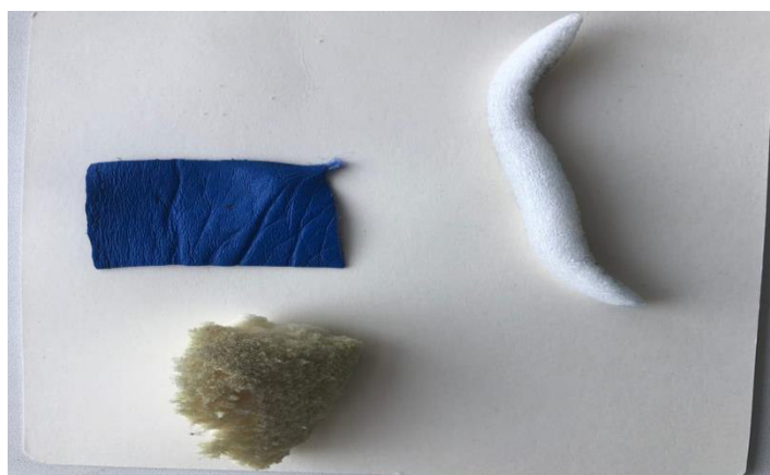
Рис. 1. Образцы материала верха и наполнителя боксерских перчаток
